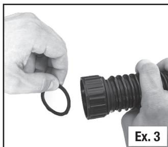
**REMARQUE :** afin d'assurer un raccordement sans fuite, une rondelle plate en caoutchouc doit être posée avec chaque raccord à bague de 1,5 po (Ex. 3).
